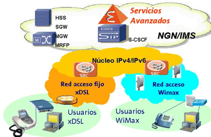
Fig. 1. Arquitectura de la plataforma precomercial GENESIS.
