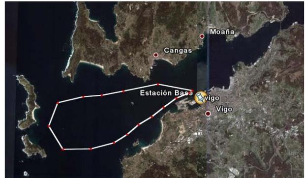
Para este caso de pruebas se obtiene en el tramo más alejado, como era de esperar, una drástica disminución de la SNR en recepción, con un valor medio de unos 5 dB. Además se observan, a lo largo de todo el trayecto descrito por la embarcación, rápidas fluctuaciones sobre el valor medio registrado. Estas fluctuaciones responden al movimiento que el oleaje produce en la embarcación y que hacen variar la dirección de apuntamiento de la antena (puesto que se empleó una antena directiva).
