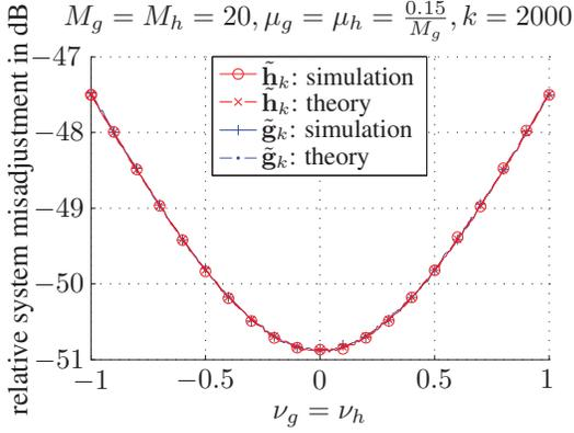
Fig. 2. Steady-state parameter error energy over  $\nu_g = \nu_h$ .
